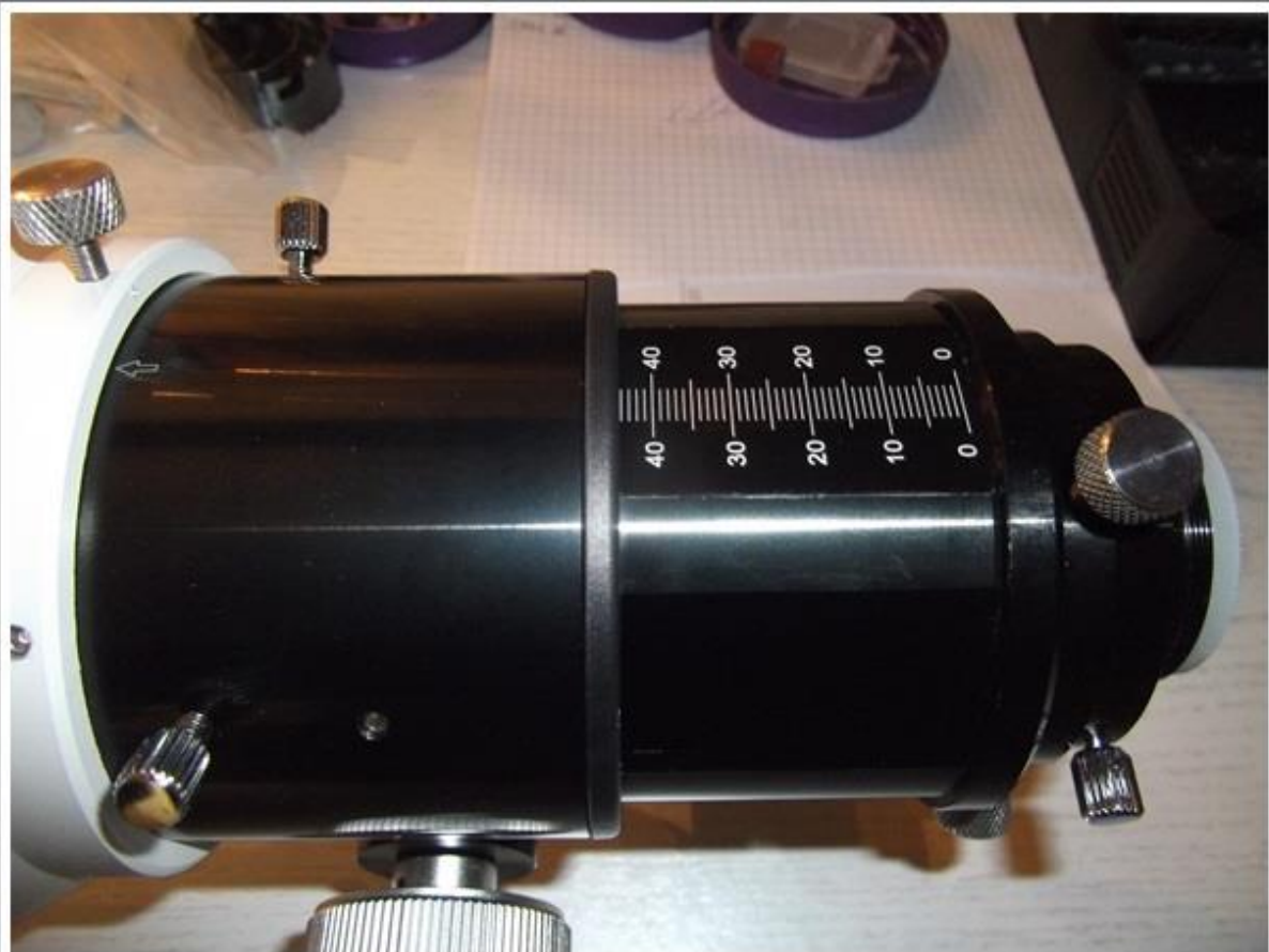
Hexafoc mit gerade einmal 45 mm Fokussierweg. Im Lieferumfang gibt es aber noch 2 Verlängerungshülsen a. 25 und 35 mm
